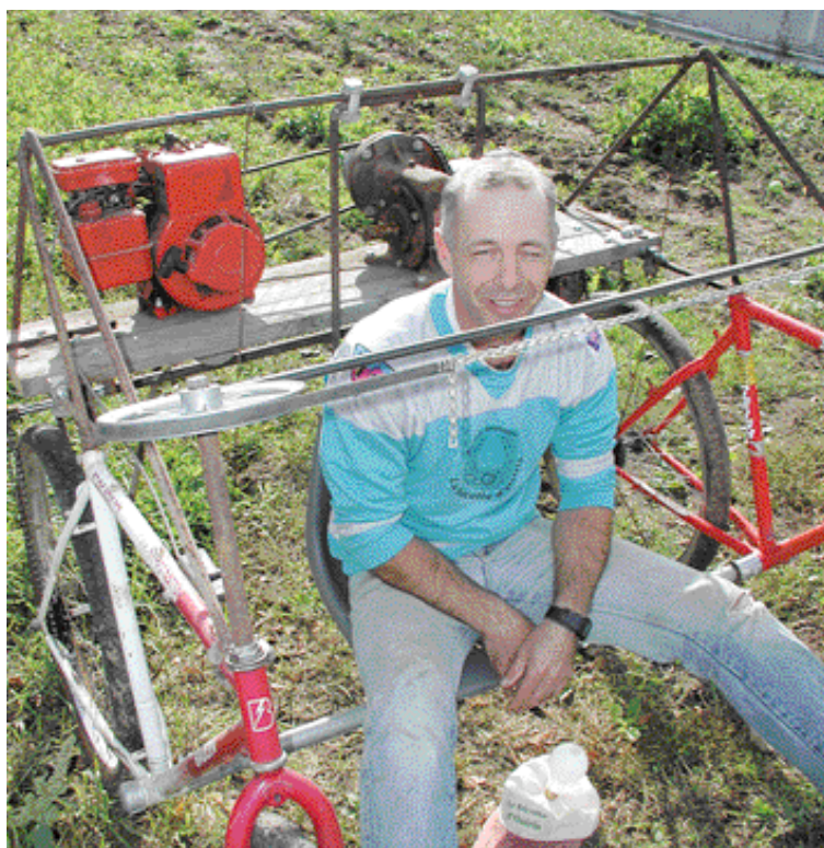
Non orthodoxe mais efficace cette récolteuse à asperges est contrôlée par les pieds et mue par un moteur de tondeuse.
